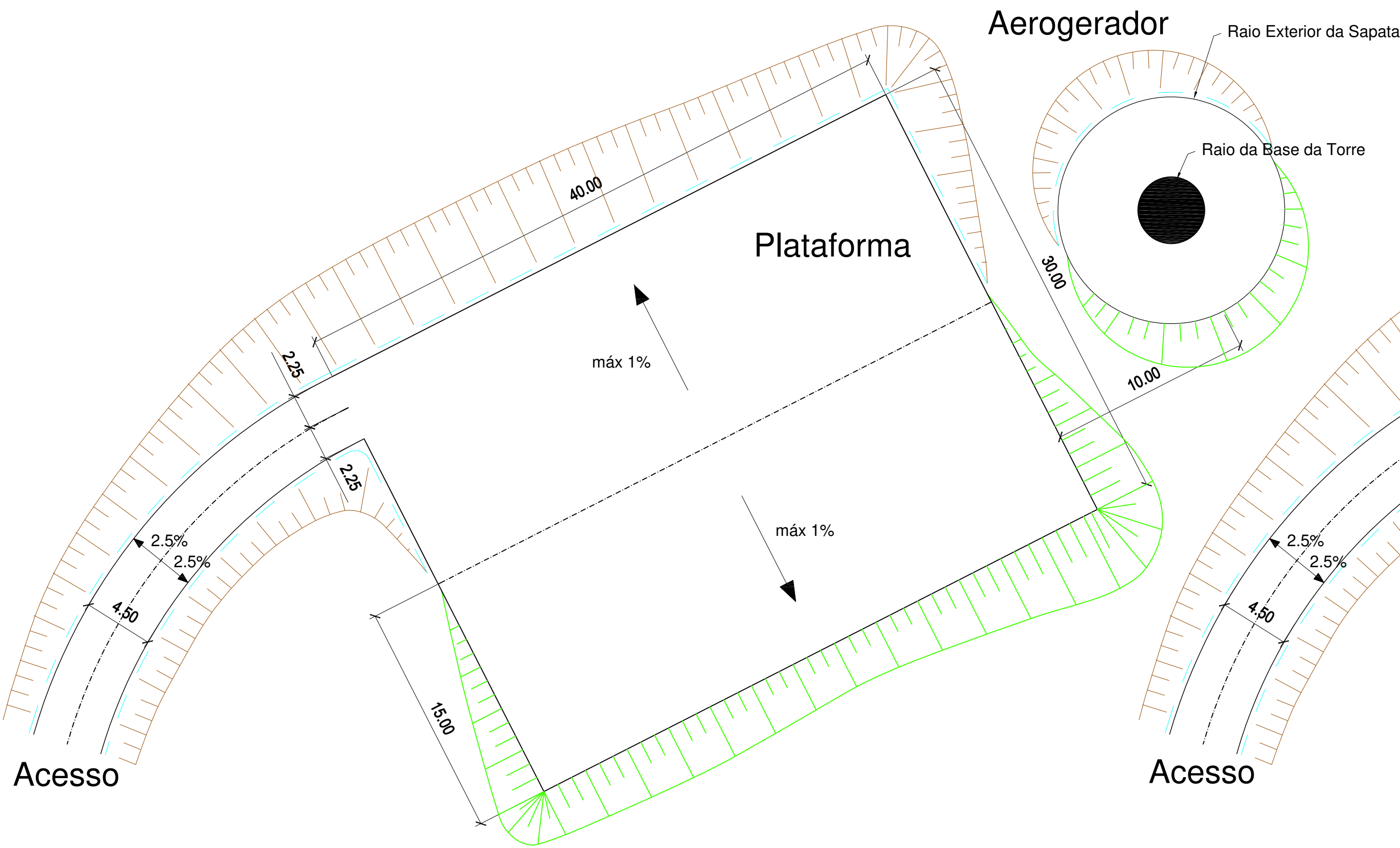
Plataforma (durante a montagem)
